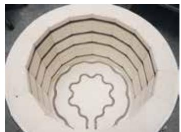
Система нагрева дна для моделей Top 140 и Top 190 в качестве дополнительного оснащения
