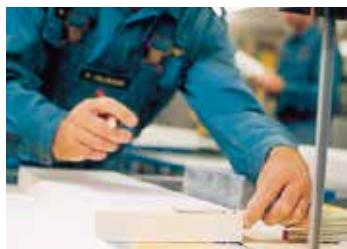
Выполняя изоляцию наших печей, мы не идем ни на какие компромиссы. Футеровка каждой печи производится вручную. Все изоляционные материалы сортируются вручную и точно используются в печи. Регулярный контроль качества всех материалов обеспечивает долговечность печи.
