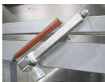
Открытие крышки при помощи двигателя в качестве дополнительного оборудования.
