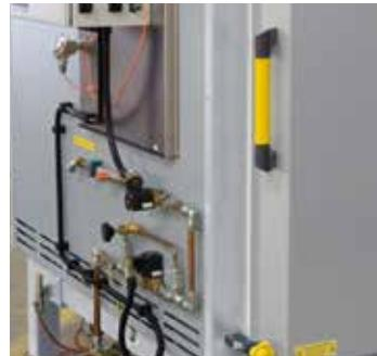
Газовое оборудование и термоэлемент в печи
