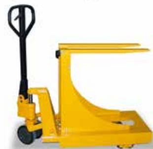
Погрузчик с установленной загрузочной рамой
