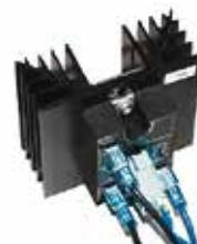
Полупроводниковые реле для управления нагревом печи. Малошумные и практически неизнашиваемые - полупроводниковые реле срабатывают с короткими тактами, оптимально адаптируя изменение температуры к кривой обжига.
