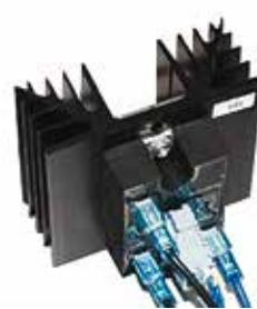
Полупроводниковое реле для переключения нагрева печи с целью оптимального уравнивания температуры по кривой обжига.
