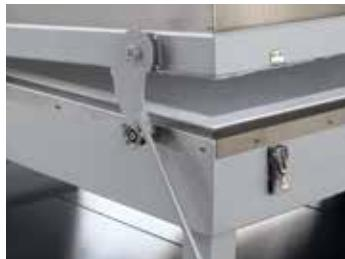
Механизм защелкивания при определенном открывании кожуха в различных положениях для ускоренного охлаждения
