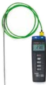
Термометр для RAKU 100, простой в обслуживании, температурный датчик NiCr-Ni, диапазон индикации 20 - 1200 °C, возможность подключения второго датчика с функцией переключения индикации
