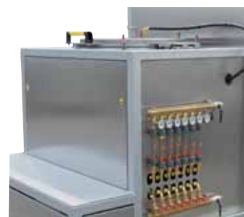
Система регулирования водяного охлаждения
