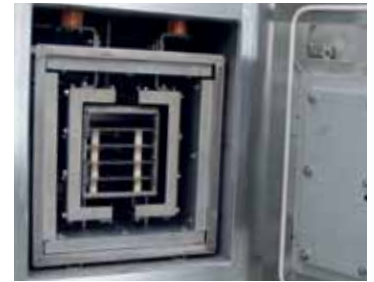
Молибденовый или вольфрамовый нагревательный элемент
