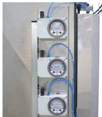
Индикаторы давления и объема потока, входящие в комплект для выжигания II
