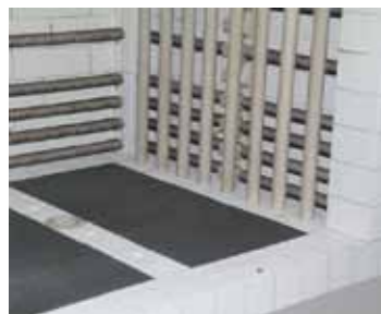
Вдувание предварительно нагретого воздуха через перфорированные трубки
