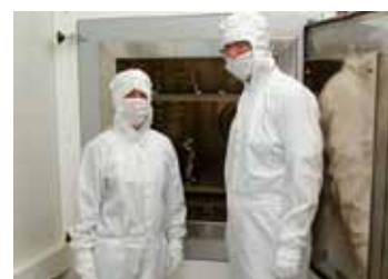
Печь с циркуляцией воздуха N 250/65NAC с пространством печи в исполнении без каких-либо частиц. Дверь печи для загрузки находится в чистом помещении, класс 100, камера печи в сером помещении за ним.
