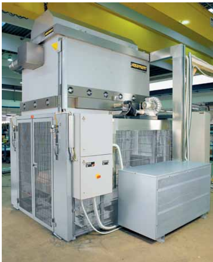
Комбинированная высокотемпературная установка НТ 1440/17 LBS с устройством каталитического дожигания для выжигания и спекания в одном процессе
