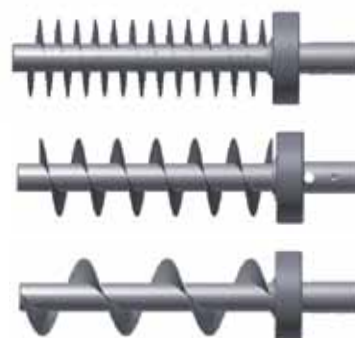
Шнековые транспортеры с различным углом подъема для регулировки подаваемого количества
