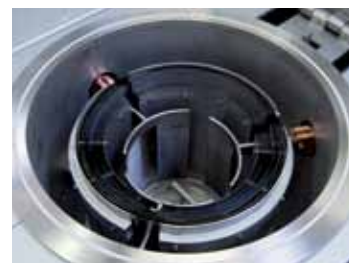
Цилиндрическая реторта с вольфрамовым нагревом
