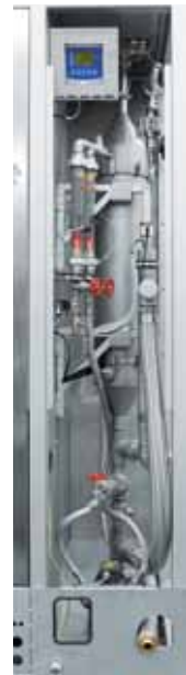
Система очистки технологических газов методом промывки
