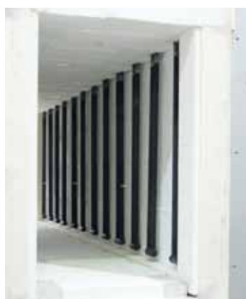
Нагревательные элементы из карбида кремния с двух боковых сторон печи
