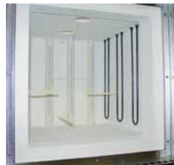
Впуск свежего воздуха через перфорированные нагнетательные трубки, входящие в комплектацию для выжигания II
