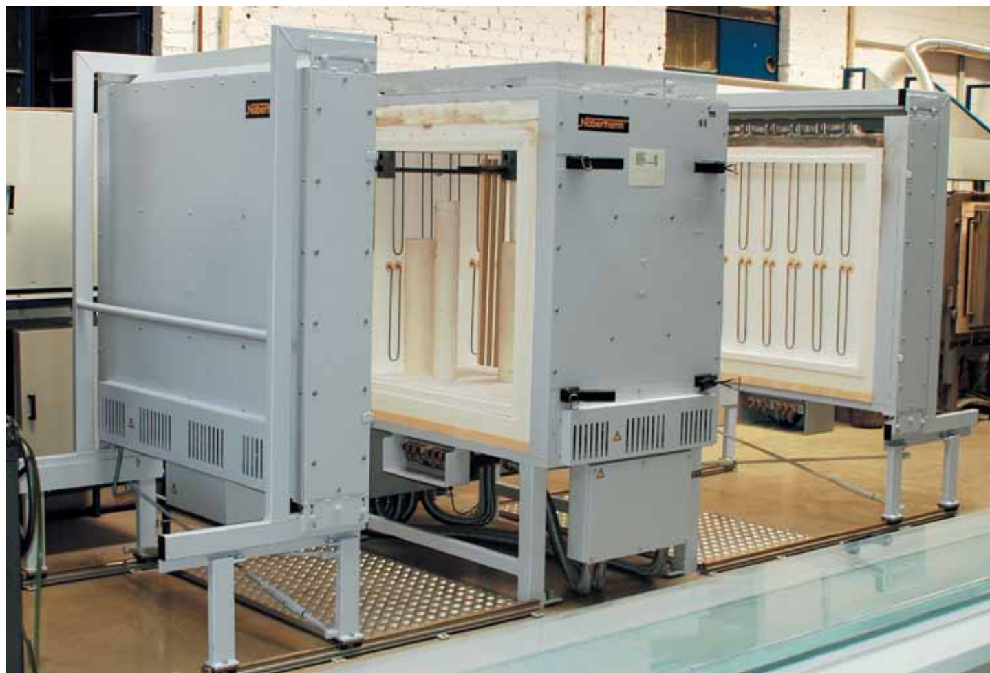
НТ 1000/17 с двумя перемещающимися дверями и системой циркулирующего нагрева для спекания труб, обработка которых еще не завершена, до 1700 °С
