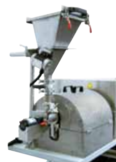
Вибрационный генератор у загрузочной воронки для оптимизации подачи порошка
