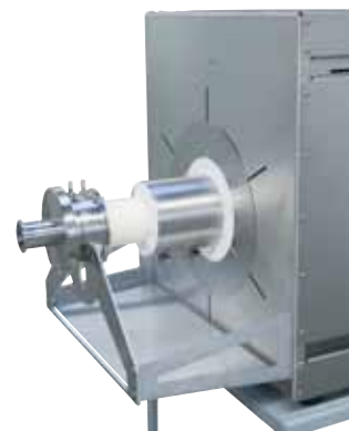
Газонепроницаемое исполнение с фланцами с водяным охлаждением
