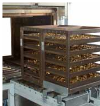
Проходная печь для термообработки клепок
