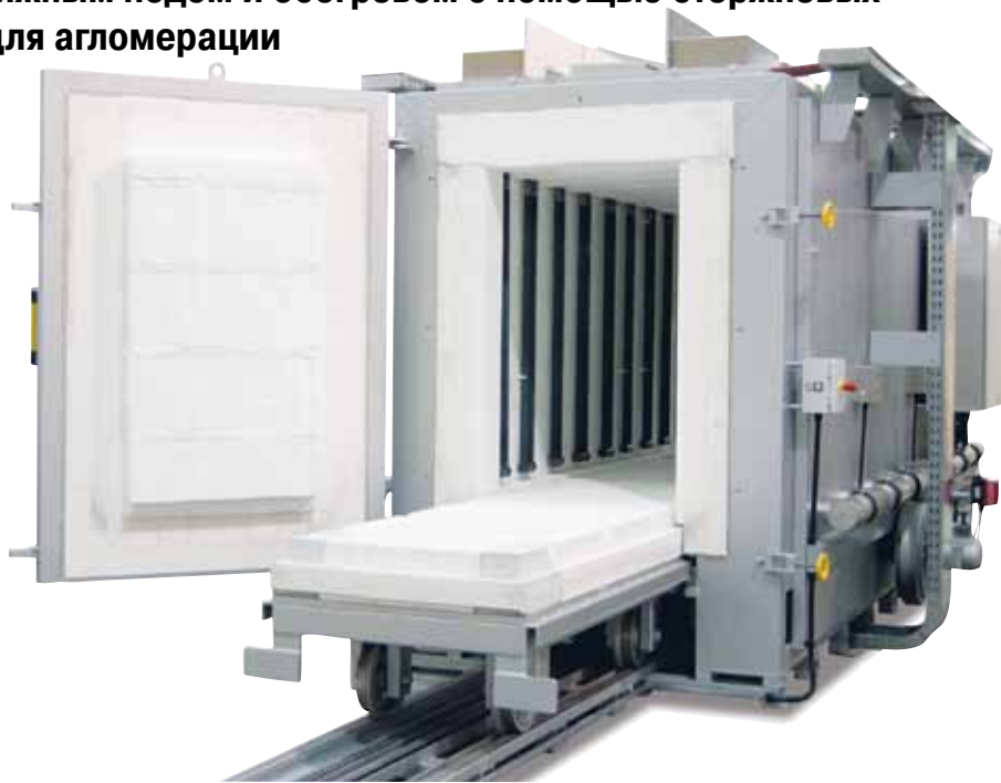
WHTC 4000/15 с выдвижным подом, перемещающаяся по направляющим и с вентиляторным охлаждением
