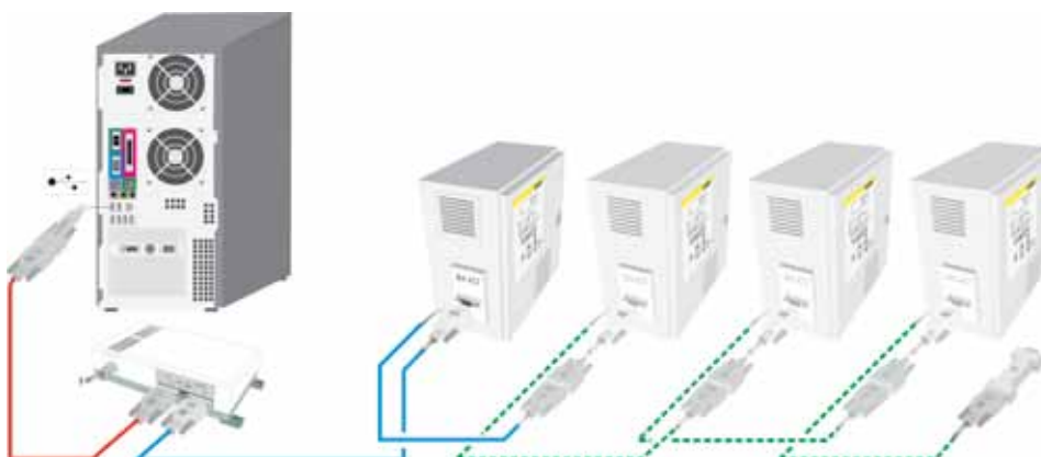
Расширения для подключения макс. 16 печей
