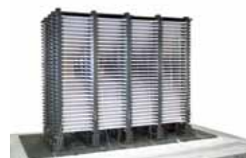
Измерительная установка для определения распределения температур в полезном пространстве печи
