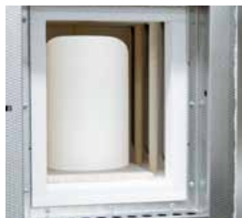
Технологический коллап с подачей газа через под печи защищает пространство печи от загрязнений, а также предотвращает химическое взаимодействие между изделиями и нагревательными элементами
