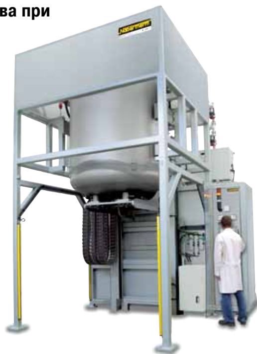
LBVHT 400/18 WO с вольфрамовым нагревательным элементом
